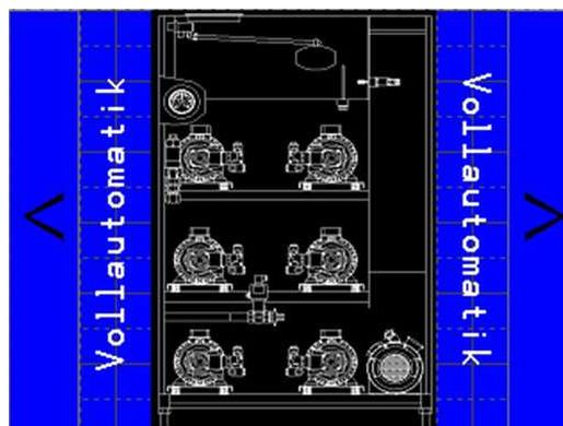
Die Vollautomatik ist ein Zeitgesteuertes Ein- und Ausschalten der Pumpen. Nach Betätigung der Taste „Pumpe Ein“ beginnt ein Programm abzulaufen das Sie selbst erstellt haben.
