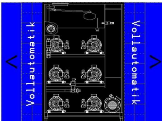
Nach der Programmauswahl gehen Sie zurück zu dem Feld der Vollautomatik und starten Sie das Programm durch Drücken der Taste „Pumpe EIN“.
