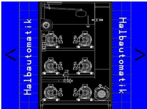
Die Halbautomatik ist ein Dauerlauf, die bei erfolgter Aktivierung des Systems, mit dem Taster „Pumpe Ein“ gestartet und dem Taster „Pumpe-Aus“ beendet werden muss. Nach Start der ersten Pumpe erfolgt das Zu – und Abschalten aller weiteren Pumpen automatisch.
