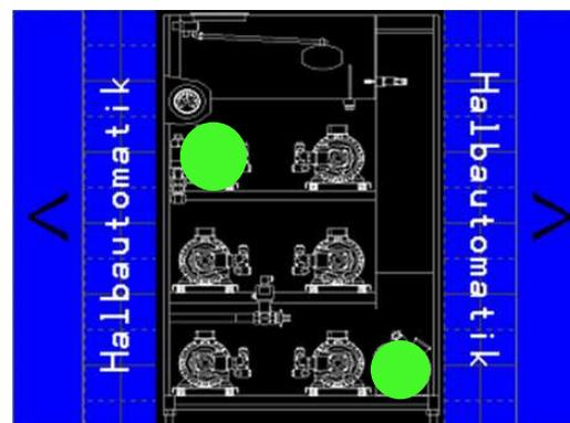
Bei starten in den zwei verschiedenen Betriebsmöglichkeiten Halb- oder Vollautomatik sehen Sie auf der Oberfläche des HMI die verschiedenen aktivierten Komponenten (z.B.: Vordruckpumpe, HD-Pumpen, etc.)
