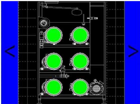
Die Schaltung ist für Wartung und Überprüfung der einzelnen Komponenten vorgesehen. Sie können hier aber auch die Pumpen beliebig und einzeln starten. Hierfür müssen Sie eine Pumpe auswählen und darauf tippen, danach auf den Taster „Pumpe Ein“. **Dieser Betrieb hat keine Schutzfunktion und muss stets von einer Person überwacht werden.**
