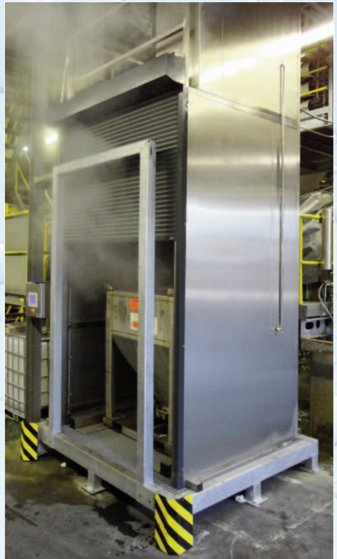
Vollautomatische Reinigungsanlage für IBC Container.
