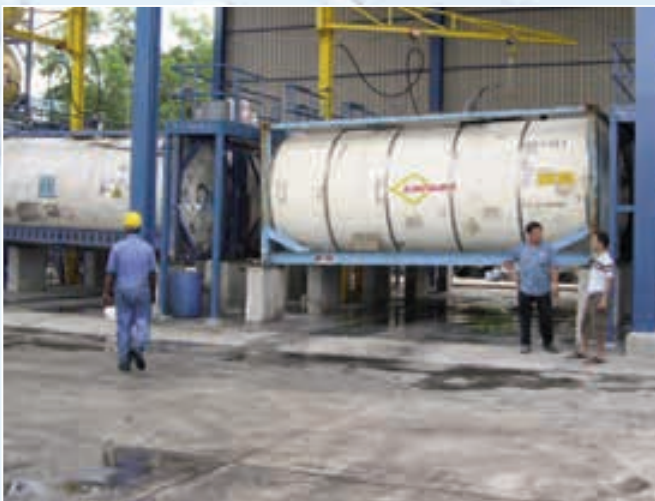
Tankreinigungsstation für die Innenreinigung von Tankcontainern.
