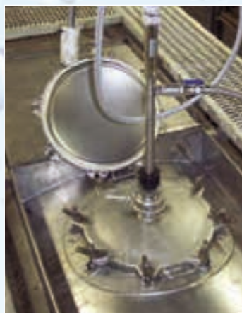
Reinigungskopf auf 20' Tankcontainer bei der Reinigung.
