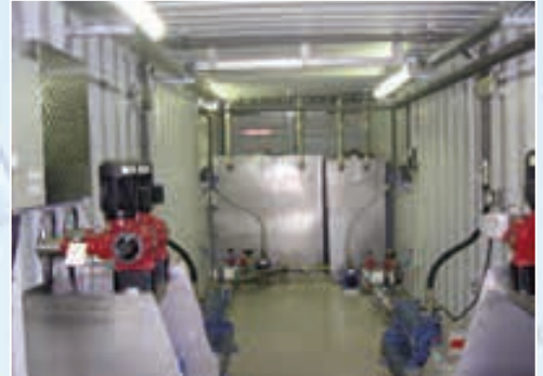
Tankinnenreinigungsanlage eingebaut in 40' Container. Zur gleichzeitigen Reinigung auf zwei Reinigungsbahnen.
