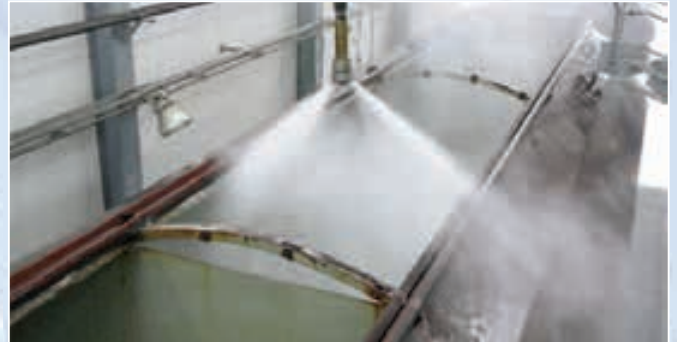
Innenreinigung eines Schüttgutwaggons der Eisenbahn.
