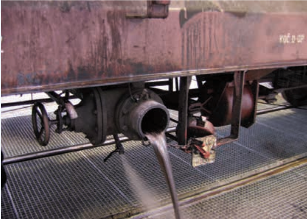
Schmutzwasser-Auslauf des Kesselwaggons.
