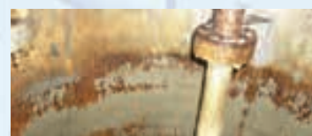
Verschmutzte Reaktortanks mit ausgehärteten Verkrustungen vor der Reinigung.
